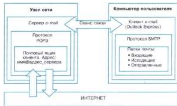
Рис. 2.2. Схема функционирования электронной почты
