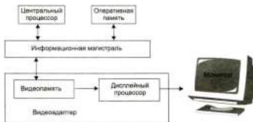
Рис. 4.9. Схема системы вывода изображения на экран
