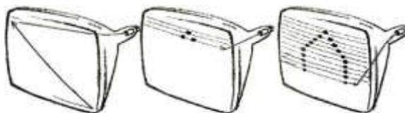
Рис. 4.8. Получение растрового изображения в электронно-лучевой трубке
