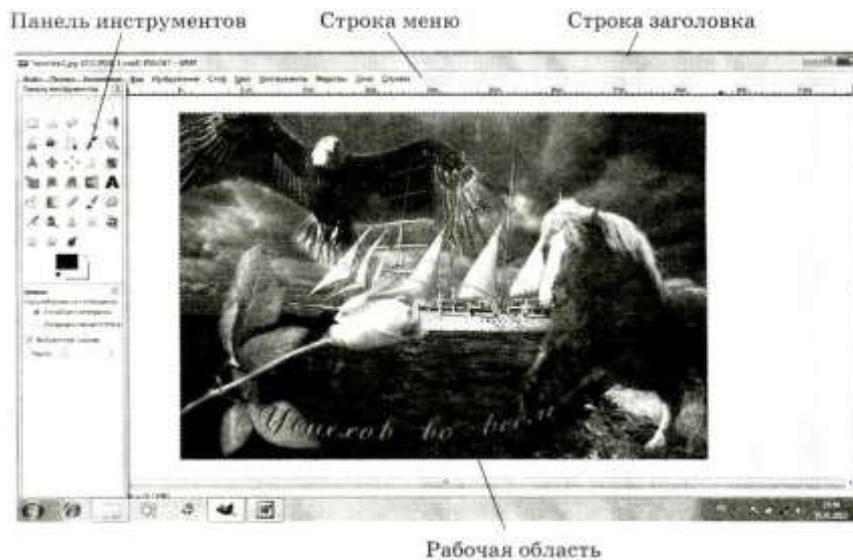
Рис. 4.15. Рабочее окно растрового графического редактора GIMP
