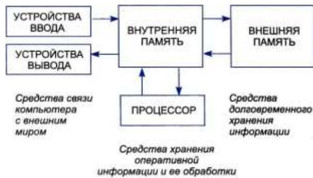
Рис. 2.3. Информационный обмен между устройствами компьютера
